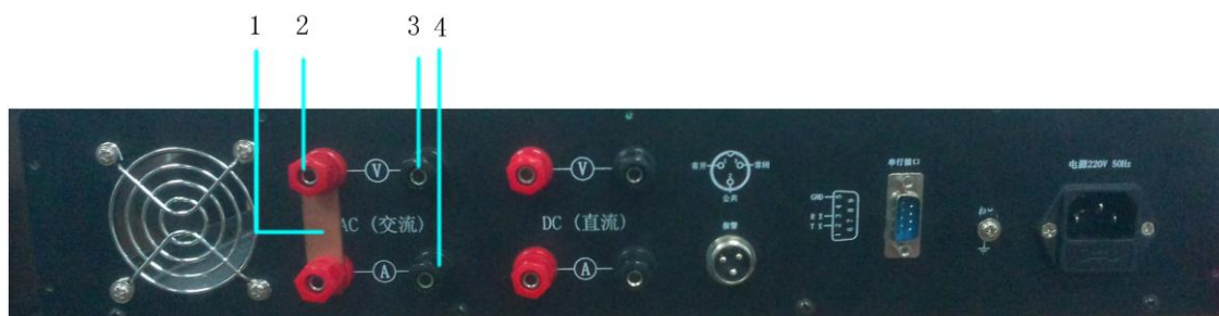
图3 测量负载接线原理图
